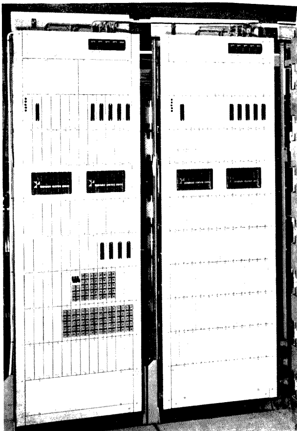
Bild 1 Unverkleidete Gestelle mit Steckeinheiten und Kernspeichern im Versuchsaufbau
