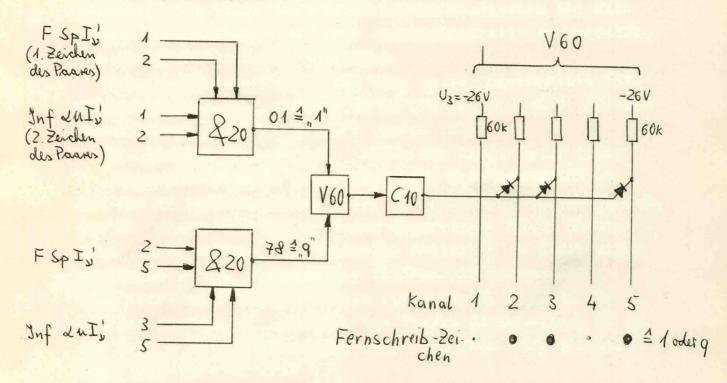
Damit der Code-Wandler nicht schon bei einer kleinen Änderung des &-Codes des ER 56 unbrauchbar wird, ist auf eine Minimisierung gemäß der Boolschan Algebra verzichtet worden. Im Aufbau der Steckeinheiten ist bereits alles vorgesehen, damit bei einer eventuellen Änderung der Zuordnung von Ziffernpaar und Fernschreib-Zeichen nur die entsprechenden Dioden umgelötet werden müssen.
