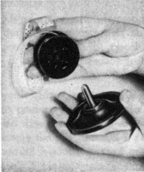
Abb. 10 Einsetzen der Lochstreifenrolle auf den Lagerzapfen
