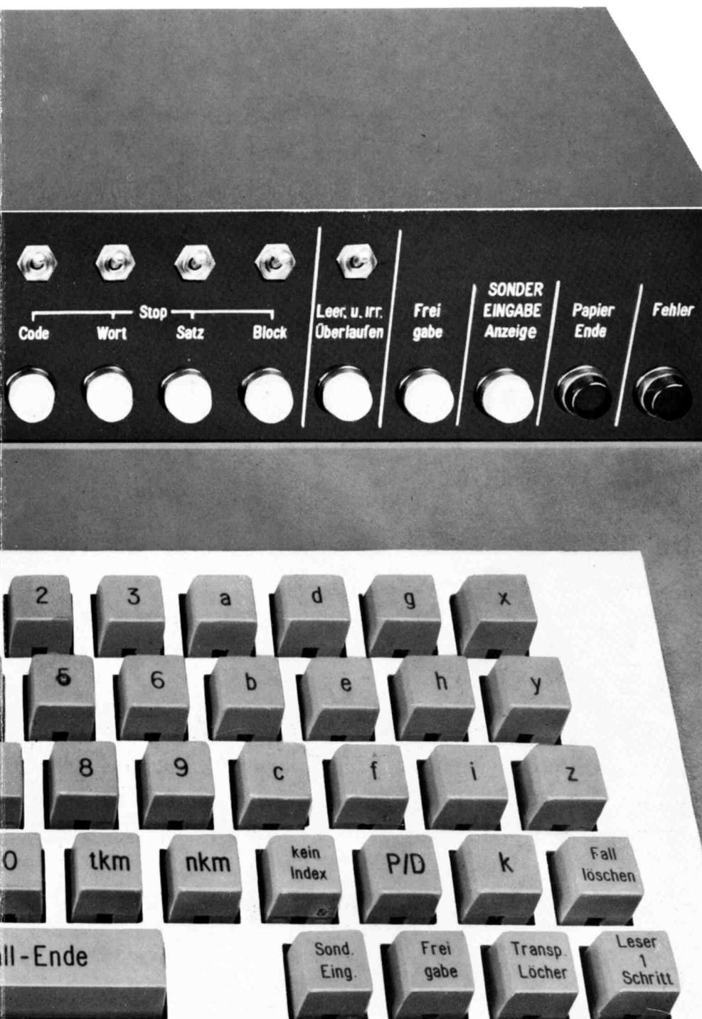
Tasten vorgesehen; jede dieser Leistungen kann so durch einen Anschlag in den Lochstreifen übertragen werden. Auswechselbare Tastenköpfe gestatten es, die Tastaturbelegung den unterschiedlichen Leistungsarten der einzelnen Facharztgruppen und den verschiedenen Gebührenordnungen anzupassen. Dadurch wird erreicht, daß mehr als 96 % aller auf dem Krankenschein stehenden Leistungen mit einem Anschlag pro Position erfaßt werden können.
