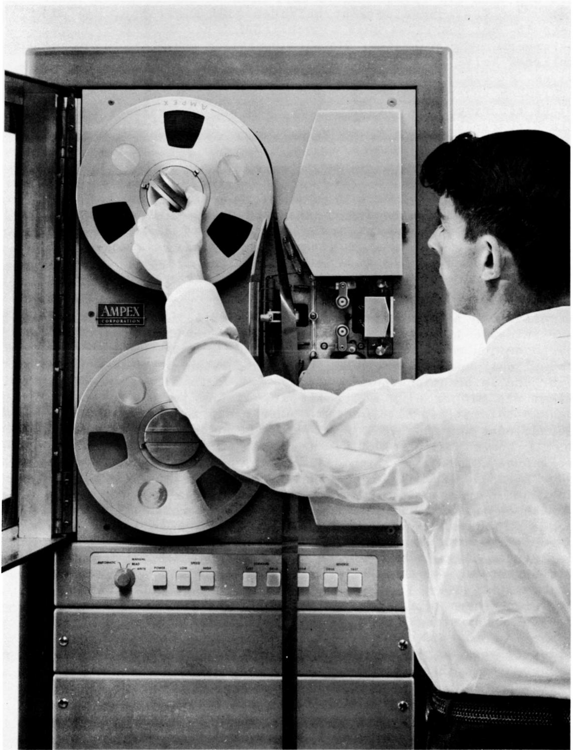
AMPEX - Laufwerk Modell FR 400 Einlegen des Bandes
