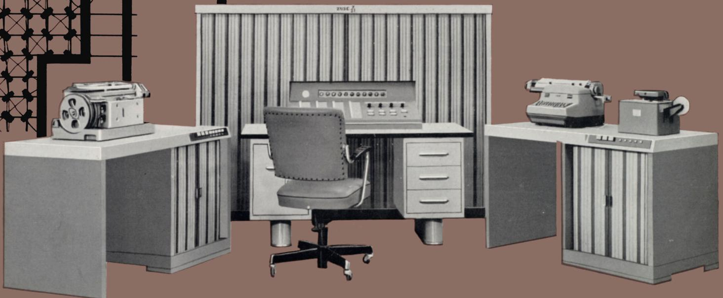
**Programmgesteuerte elektronische Rechanlage in Transistor-Technik
