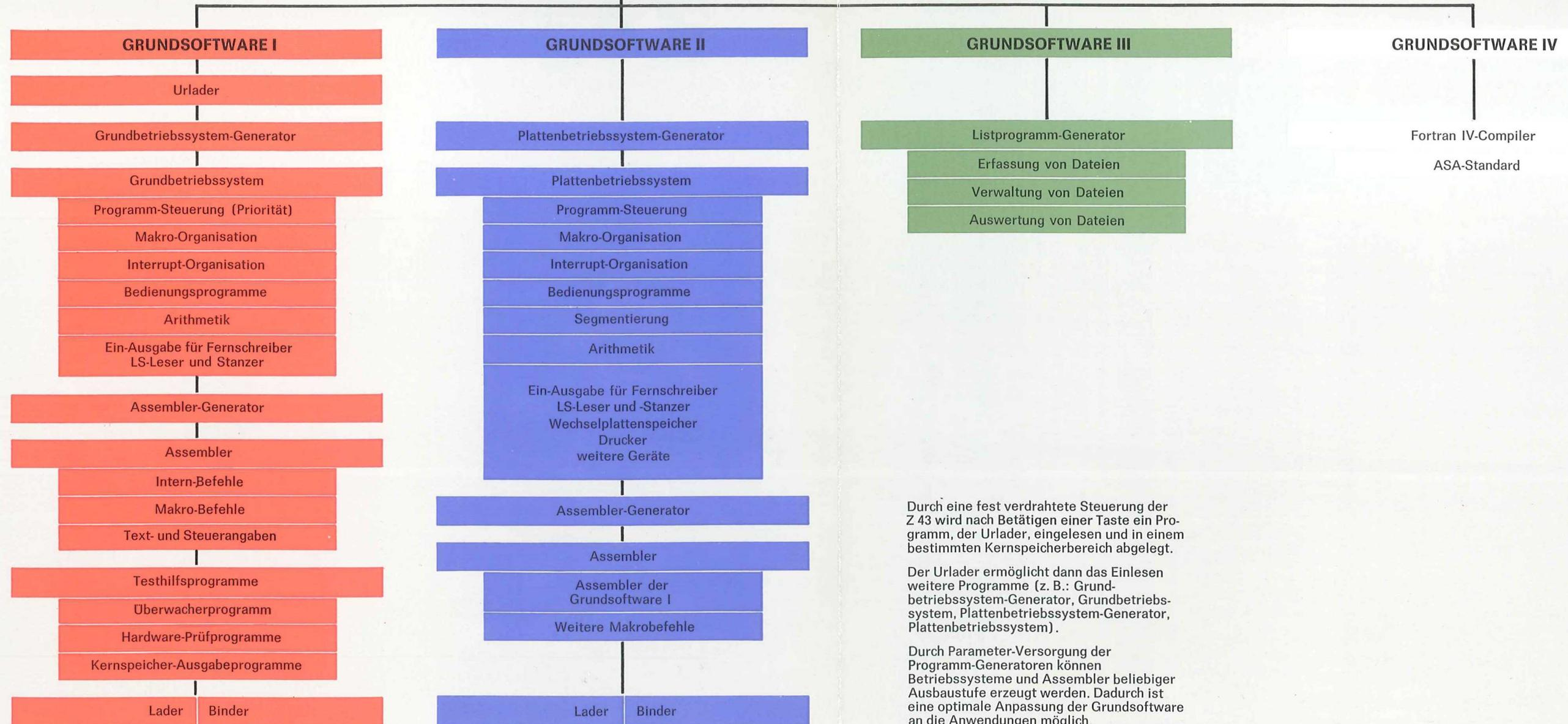
Durch eine fest verdrahtete Steuerung der Z 43 wird nach Betätigen einer Taste ein Programm, der Urlader, eingelesen und in einem bestimmten Kernspeicherbereich abgelegt.
